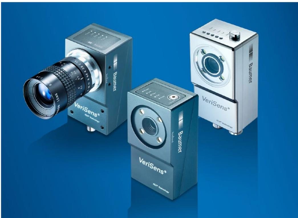
Vision Sensoren sind kompakte Bildverarbeitungssysteme im Sensorformat, die in einem industrietauglichen Gehäuse alles integrieren, um Inspektionsaufgaben zu lösen (links im Bild im C-Mount Design mit Blitzcontroller, rechts im IP 69K Schutzgehäuse, vorn mit integrierter Optik und weisser Beleuchtung).
