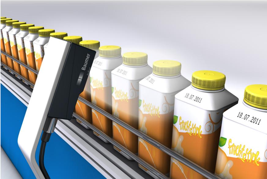
Der Vision Sensor VeriSens® ID-110 ist ideal zur Qualitätskontrolle für Endverpackungen und wird zum Beispiel dem Aufdruckprozess direkt nachgeschaltet. Dabei liest er das aufgedruckte Mindesthaltbarkeitsdatum und prüft es auf Richtigkeit sowie Lesbarkeit.
