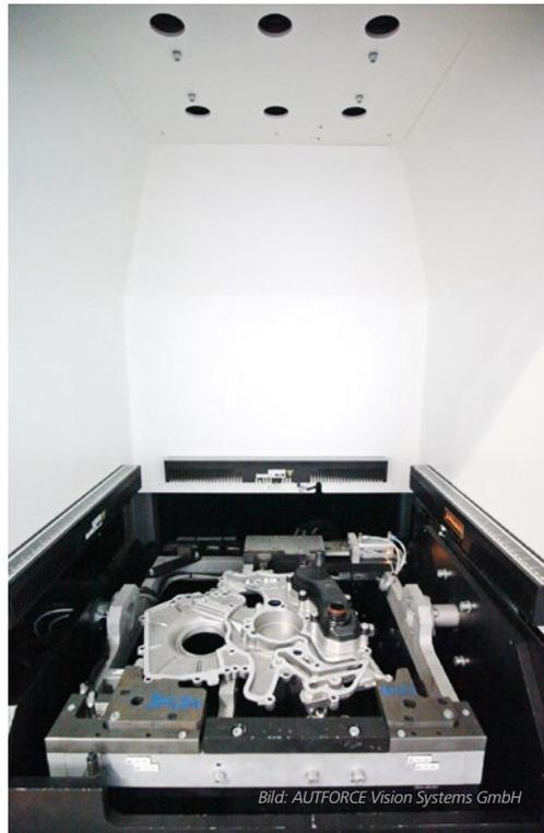
Der kuppelförmige Beleuchtungsraum ermöglicht eine optimale Ausleuchtung, um die Fräsriefen der Bauteile herauszufiltern.
