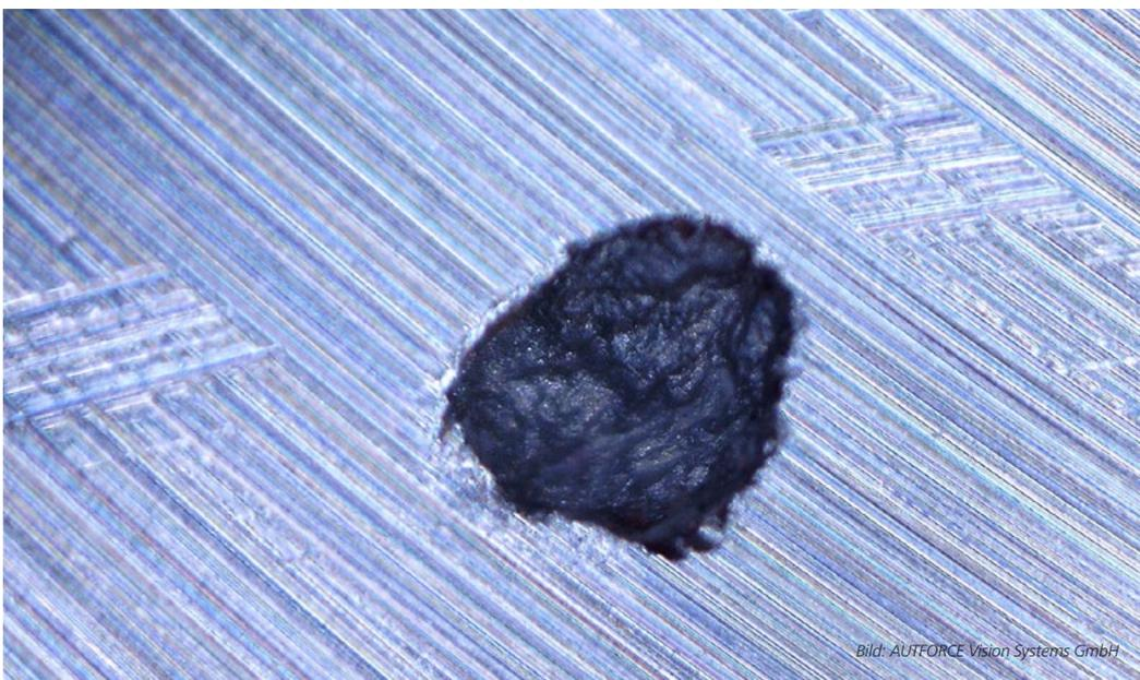
Kleine Hohlräume, die durch das Schwinden des Werkstoffvolumens bei der Abkühlung und Erstarrung der Schmelze gegossener Bauteile entstehen, können die Funktion gegossener Bauteile beeinträchtigen.
