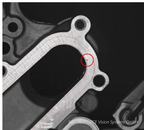
Bei 350 × 400 mm großen Bauteilen werden Lunker ab 0,4 mm zuverlässig erkannt und in Lage und Größe dokumentiert.
