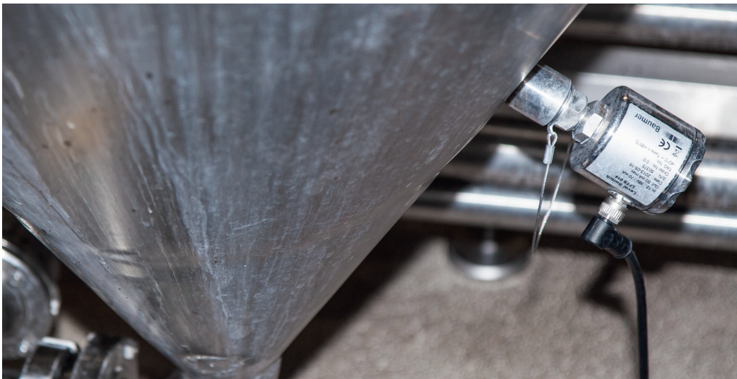
Der Füllstandschalter CleverLevel in einem seiner vielseitigen Anwendungsbereiche: Hier im Puffertank.
