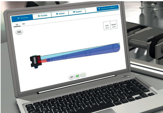
Image 4 : La trajectoire de faisceau est intégrée dans les données CAO 3D. Ceci facilite le processus allant de la conception au montage, car le détecteur peut être installé exactement comme il a été conçu, sans nécessiter de réglage fin.
