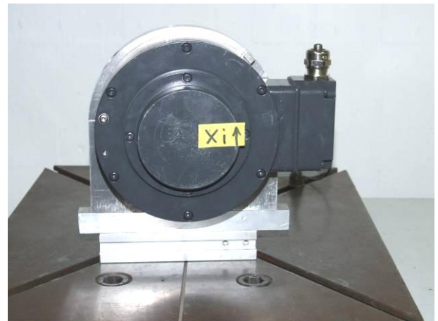
Bild 8 Drehgeber HOG 16 auf dem auf dem Stoßtisch mit Beschleunigungssensor beim Schocken in der X-Achse, negative Richtung
