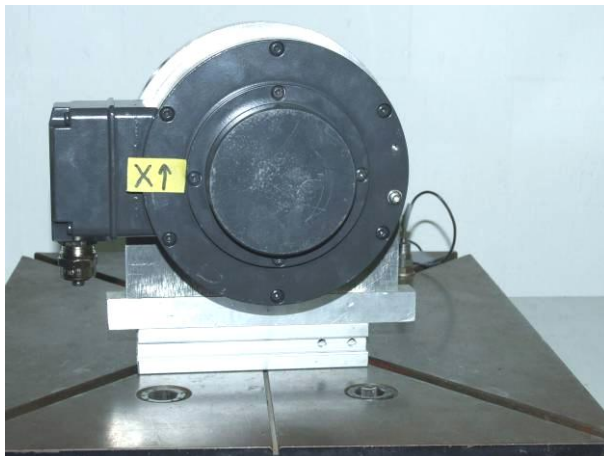
Bild 7 Drehgeber HOG 16 auf dem Stoßtisch mit Beschleunigungssensor beim Schocken in der X-Achse, positive Richtung
