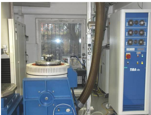
Bild 5 Drehgeber HOG 16 auf der Schwingprüfanlage beim Schwingen in der Z-Achse
