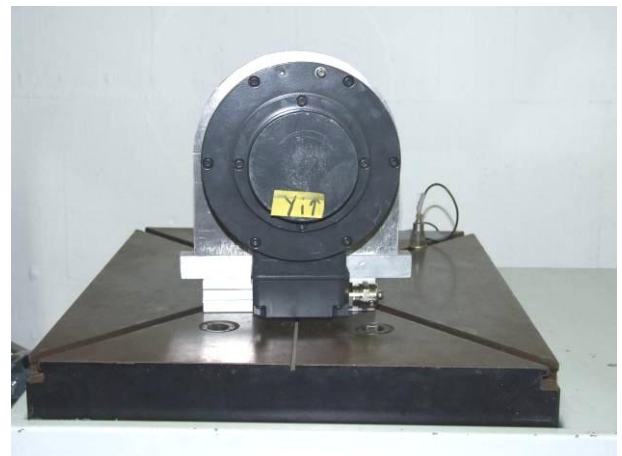
Bild 10 Drehgeber HOG 16 auf dem auf dem Stoßtisch mit Beschleunigungssensor beim Schocken in der Y-Achse, negative Richtung
