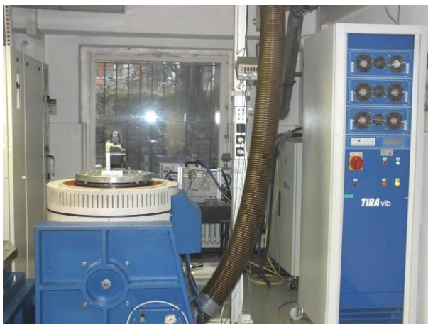
Bild 3 Drehgeber HOG 16 auf der Schwingprüfanlage beim Schwingen in der Y-Achse
