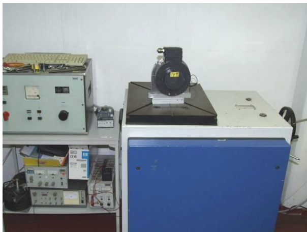
Bild 9 Drehgeber HOG 16 auf dem Stoßtisch mit Beschleunigungssensor beim Schocken in der Y-Achse, positive Richtung
