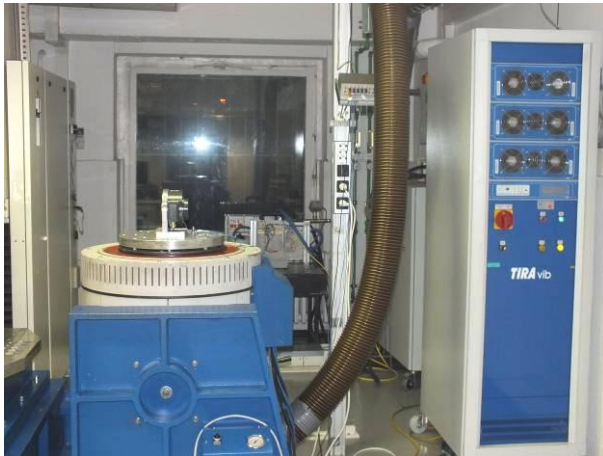
Bild 1 Drehgeber HOG 16 auf der Schwingprüfanlage beim Schwingen in der X-Achse
