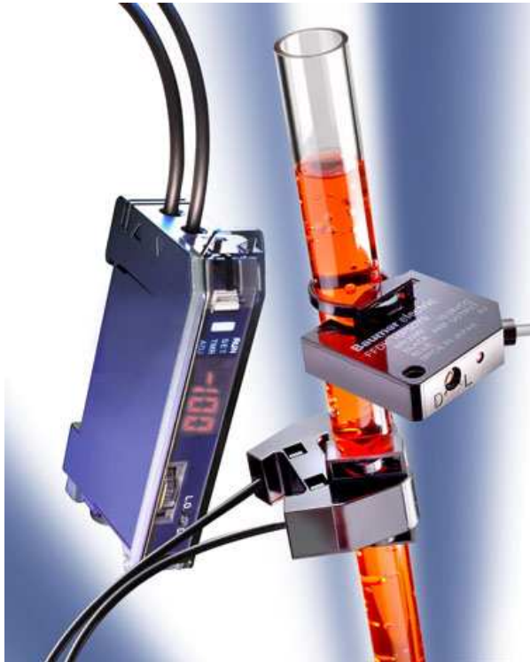
Lichtleiterausführung und Sensor mit integrierter Elektronik
