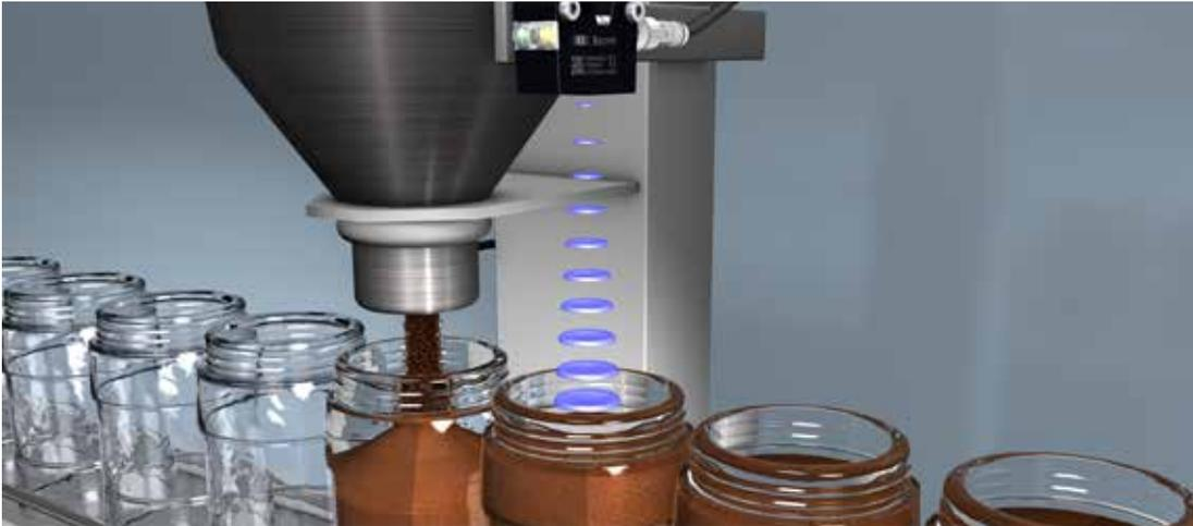
La largeur du faisceau acoustique des nouveaux détecteurs à ultrasons de Baumer se règle sur place en fonction de l'ouverture du récipient et du milieu concerné. Ce faisceau doit être étroit quand il s'agit de mesurer un niveau de remplissage à travers une ouverture étroite.
